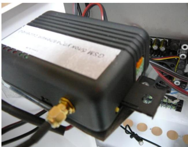
Для извлечения слайдера необходимо нажать желтую кнопку, до выдвижения его, из корпуса GSM блока, на 5-7 мм. После установки SIM карты в слайдер(правильность установки контролируют по срезанному углу), его утапливают в корпус легким нажатием.
