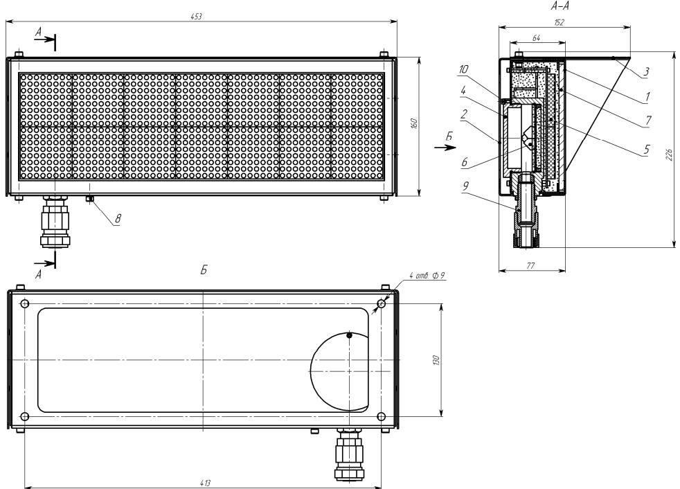
1 – корпус; 2 – кронштейн; 3 – козырек; 4 – клеммная коробка; 5 – плата индикации; 6 – плата клемм; 7 – стекло; 8 – винт заземления; 9 – кабельный ввод; 10 – стопорный винт.
