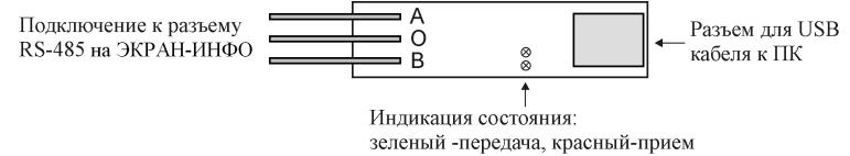
Рисунок 6. Расположение контактов преобразователя ПИ1.
