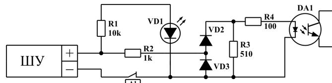
**Рисунок 10.** Схема каскада входа управления ШУ УУО
