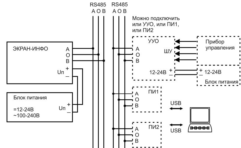
Рисунок 8. Схема соединений ЭКРАН-ИНФО, УУО, ПИ1 и ПИ2.
