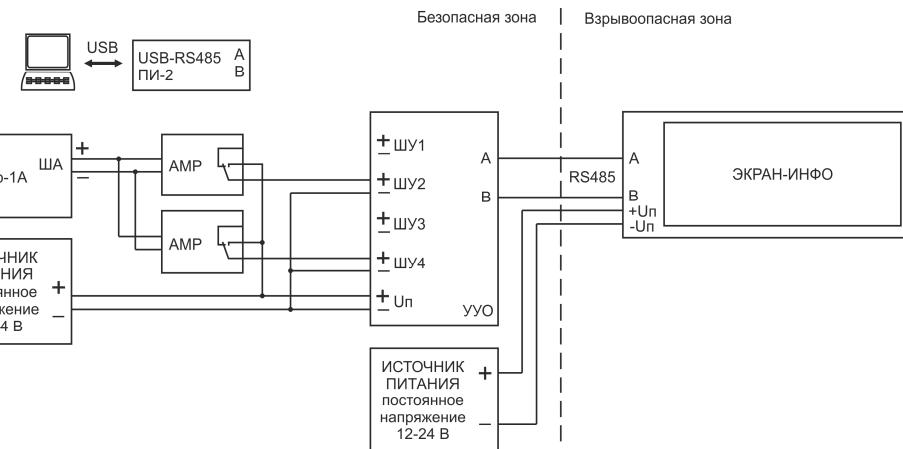
**Рисунок 13.** Пример подключения оповещателя ЭКРАН-ИНФО в адресный шлейф прибора Дзор-1А через адресные метки реле AMP и устройство управления УУО.
