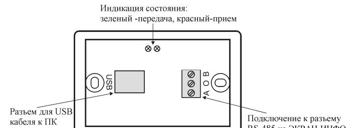
Рисунок 7. Расположение разъемов преобразователя ПИ2.
