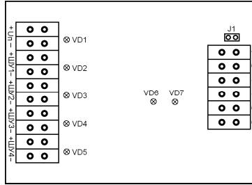
Рисунок 4. Расположение клемм устройства управления оповещателем УУО.
