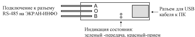
Рисунок 5. Расположение контактов преобразователя ПИ1.
